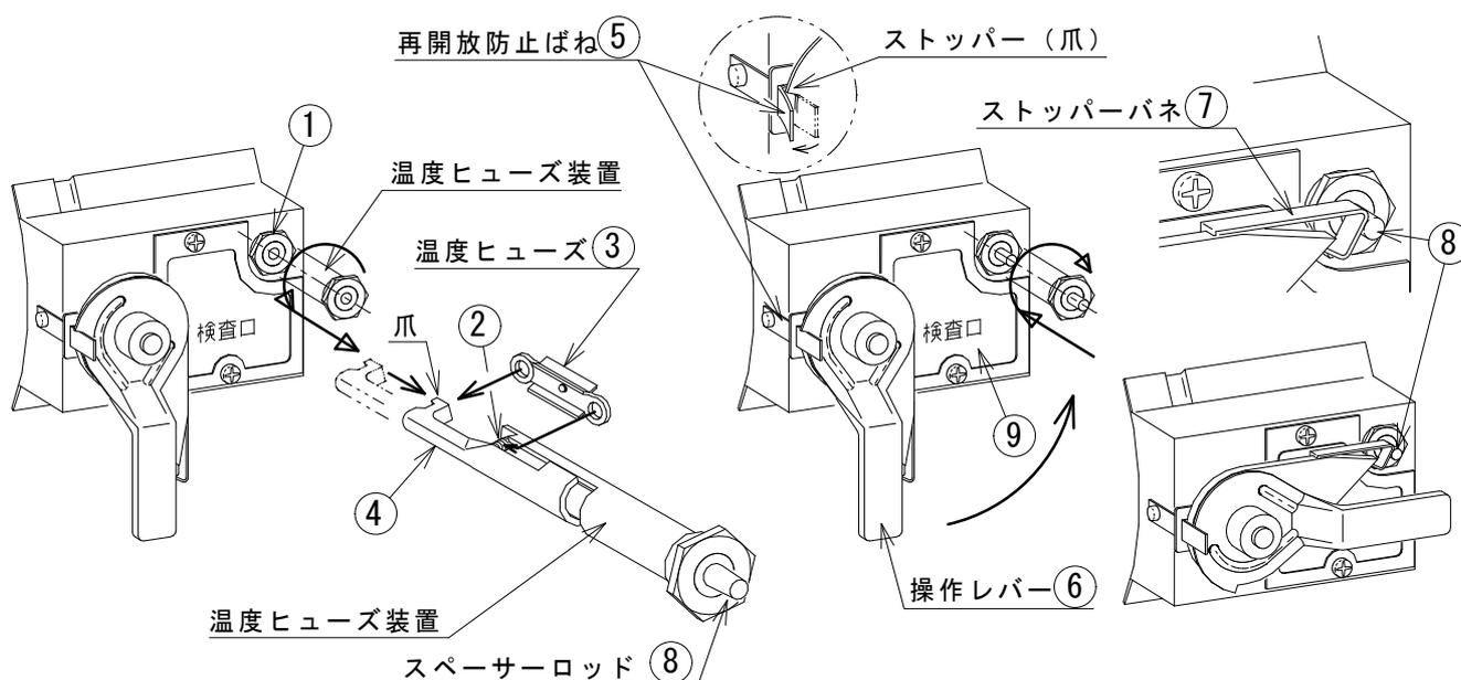
1. 温度ヒューズ装置の六角頭部①をスパナ(21mm)または、モンキーレンチを用いて回し、閉鎖装置より温度ヒューズ装置を抜取る。
